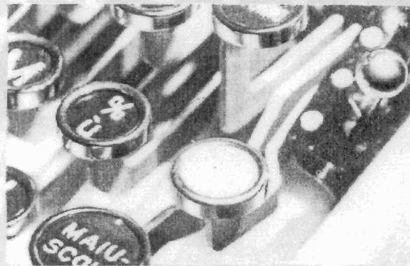
La macchina è fornita di tabulatore per fermare il carrello in posizioni determinate. L'impostazione e l'annullamento di ogni singolo arresto sono ottenuti automaticamente con un'unica leva. Tutti gli arresti possono essere contemporaneamente annullati col semplice abbassamento di un'altra leva.
